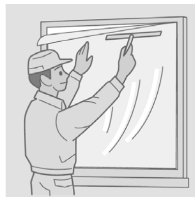
ガラス飛散防止フィルムの貼付
