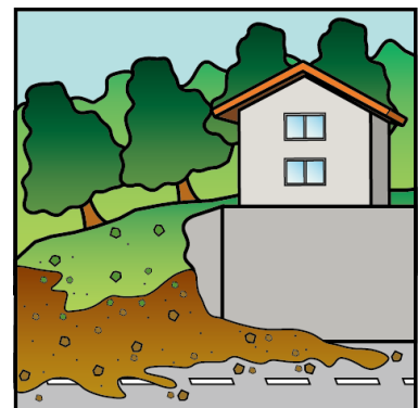
4-③-ア 擁壁の欠損イメージ
