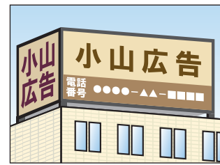
色彩を外壁と同じ色調にした例
