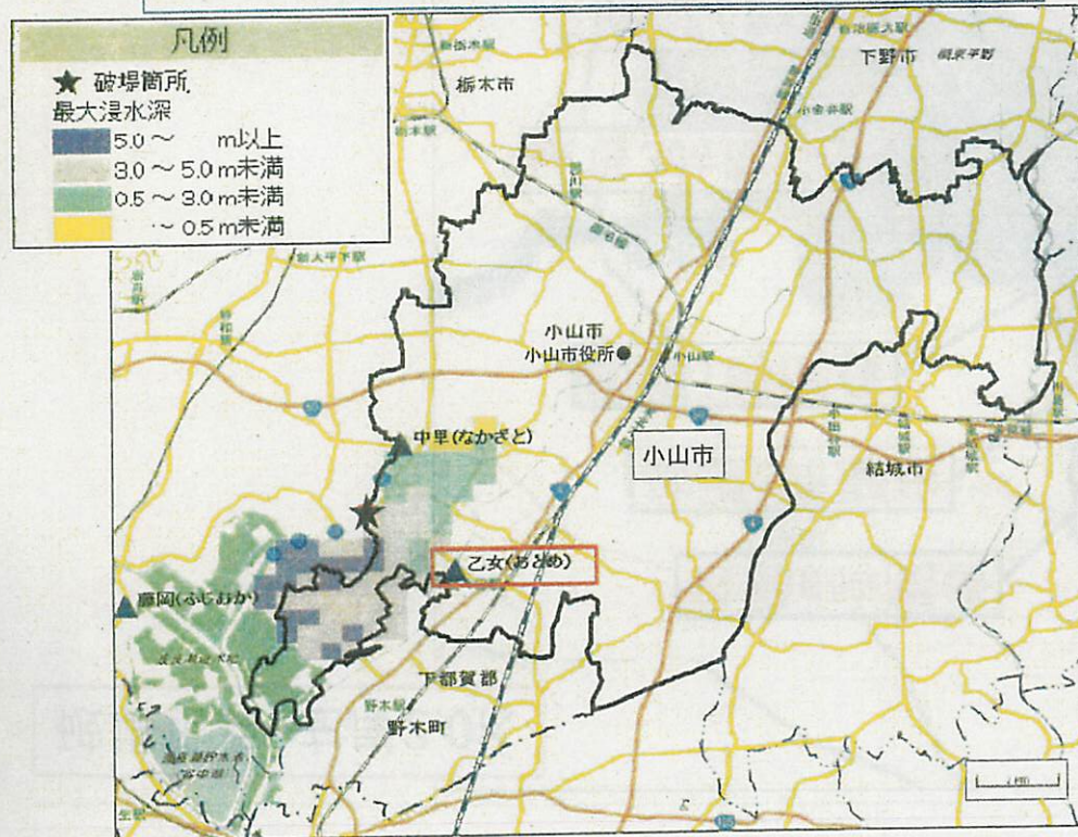
巴波川左岸2.0k付近が決壊した場合の最大浸水深の例 範囲(計画規模相当の洪水の場合)
