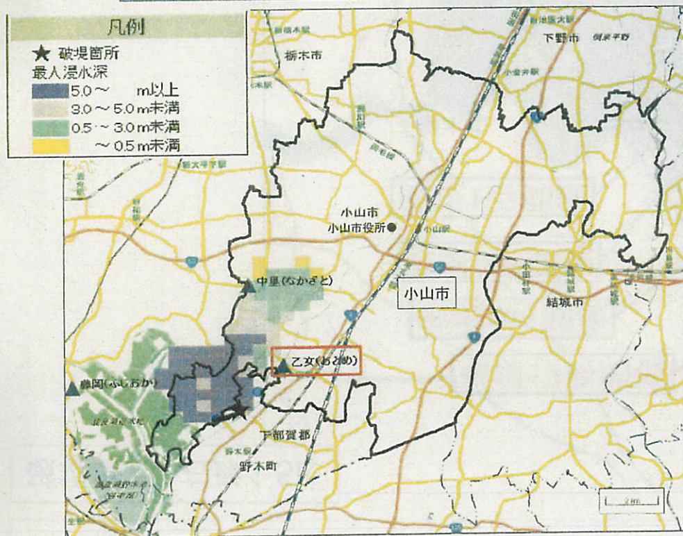
思川右岸1.5k付近が決壊した場合の最大浸水深の範囲(計画規模相当の洪水の場合)
