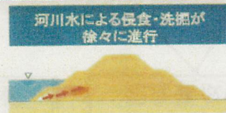
侵食・洗掘破壊 イメージ図
