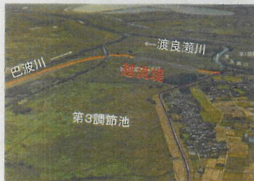
⑦第3越流堤 (延長: 496.5m)
