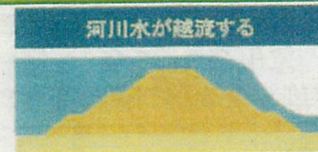
河川水の越水による堤防決壊 イメージ図
