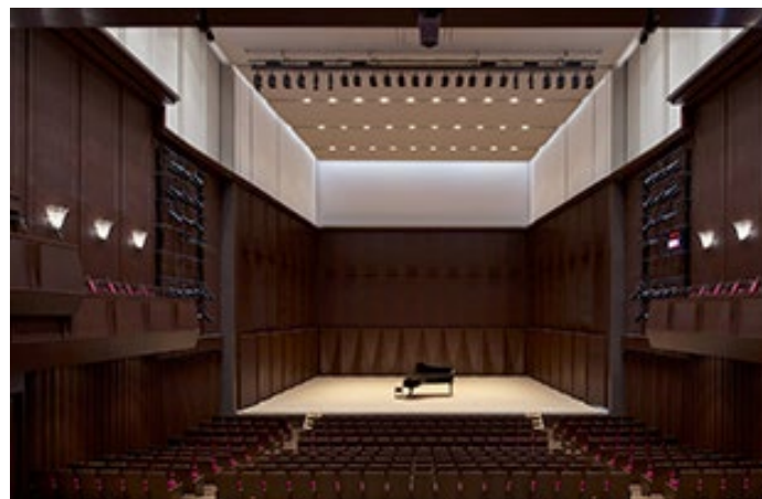
渋谷区文化総合センター大和田 さくらホール (735席) ・多目的に使えるように幕設備をもちながら、 天井を高くすることで高い音響性能を確保
