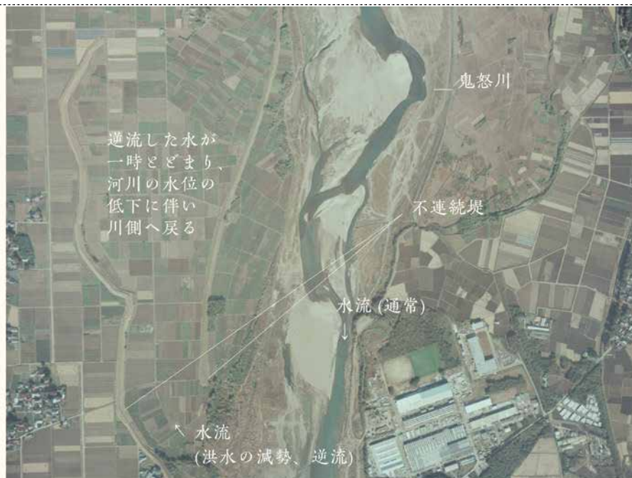
鬼怒川右岸の不連続堤。絹地区(福良)空中写真、1986/11/06撮影。出典:国土地理院|空中写真閲覧サービス https://geolib.gsi.go.jp
