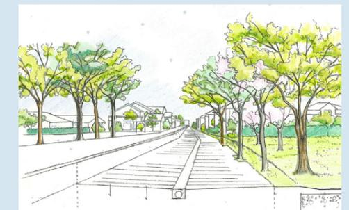
豪雨時、台地の上では谷の部分に水が集まります。この部分で雨水を貯めて地下に浸透させる、治水と水循環の両立を図ります。
