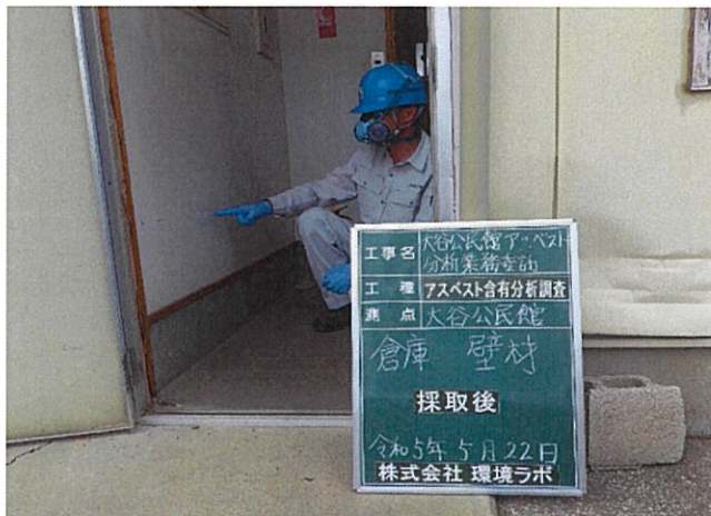
大谷公民館 倉庫 内壁 壁材 採取後
