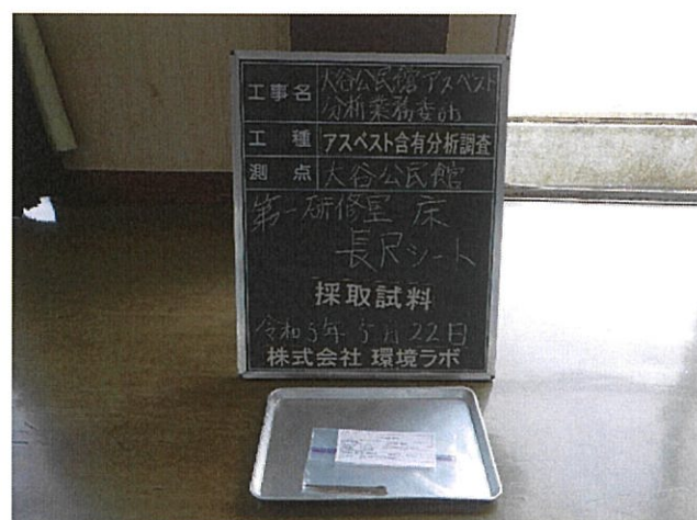
大谷公民館 第一研修室 床 長尺シート 採取試料
