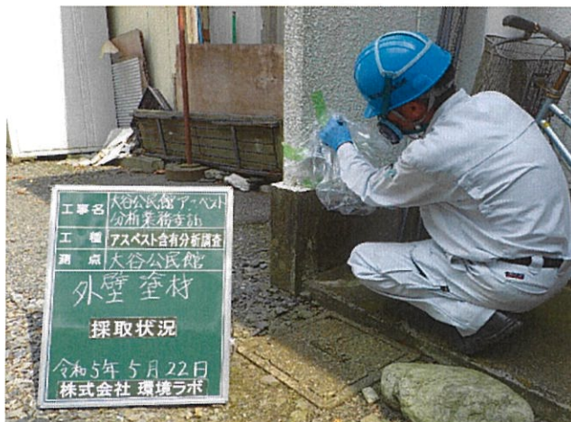
大谷公民館 外壁 外壁塗材 採取状況
