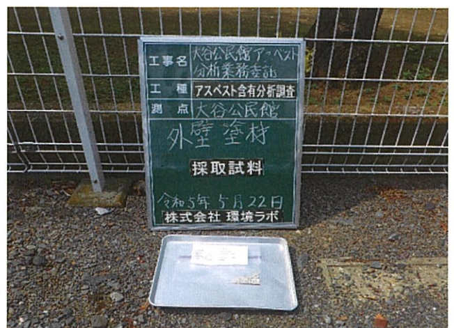
大谷公民館 外壁 外壁塗材 採取試料
