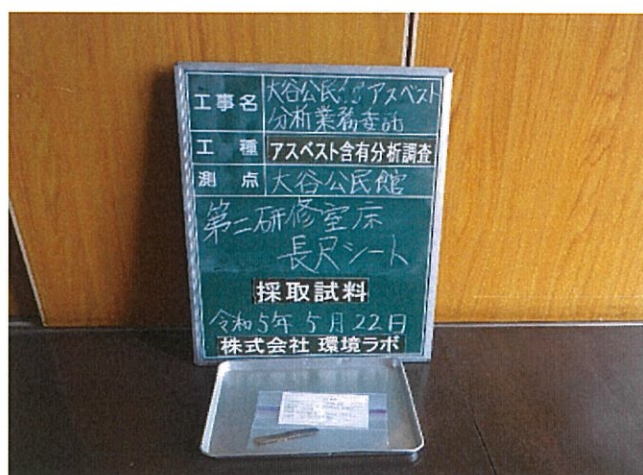
大谷公民館 第二研修室 床 長尺シート 採取試料
