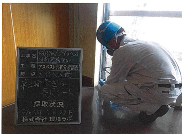
大谷公民館 第二研修室 床 長尺シート 採取状況
