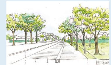
豪雨時、台地の上では谷の部分に水が集まります。この部分で雨水を貯めて地下に浸透させる、治水と水循環の両立を図ります。
